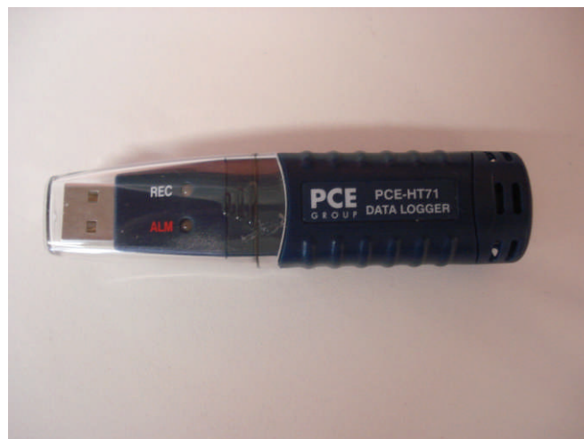
Meß- und Datenspeichergerät für Raumtemperatur und relative Luftfeuchtigkeit
